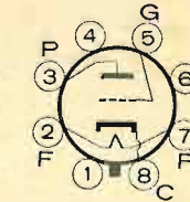
Fig. 2. - Collegamenti allo zoccolo della valvola 6J5 GT.
